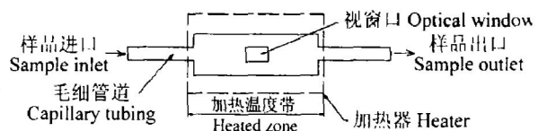
图 1 基于单直通式可视化 PCR 微装置示意图
